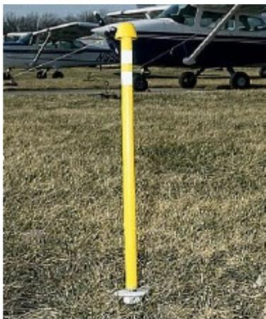
Figura 31. Baliza en una pista no pavimentada.
