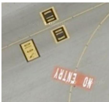
Figura 7. Marca de NO ENTRY en el aeropuerto de LEBL. No se debe penetrar en esa área.
