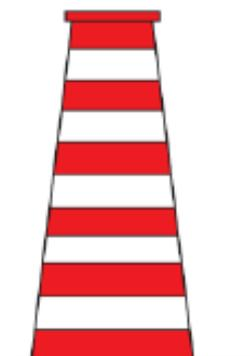
Figura 34. Obstáculo a la navegación. Resaltado con color rojo y blanco. Debe ser fácilmente visible desde el aire.
