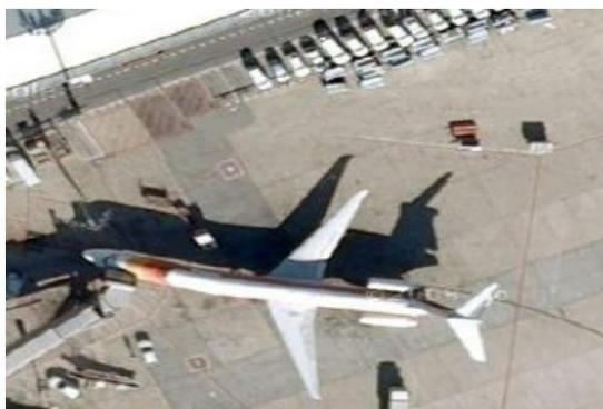
Figura 6. *Apron safety line* de un stand en el aeropuerto de Barcelona – El Prat. En la foto, un MD88 de Iberia.
